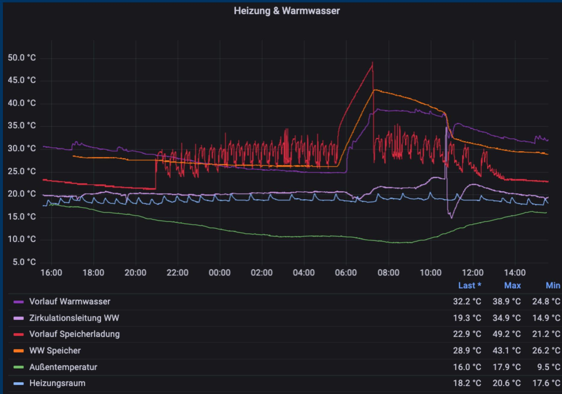
Optimierung der Warmwasserbereitung führte zu 50% Energieeinsparung bei der Warmwassererzeugung.
